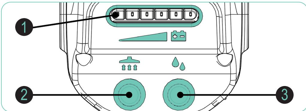
1 : BATTERY CHARGE LEVEL METER 2 : VACUUM ON / OFF SWITCH 3 : WATER FLOW ON / OFF SWITCH
